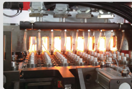
C 加熱系統 Heating System
