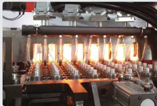
C 加熱系統 Heating System
